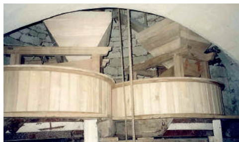
Grézillé : Moulin de Gasté paire de meules et engrenage du remonte sac ©DR https://moulin-gaste.com
